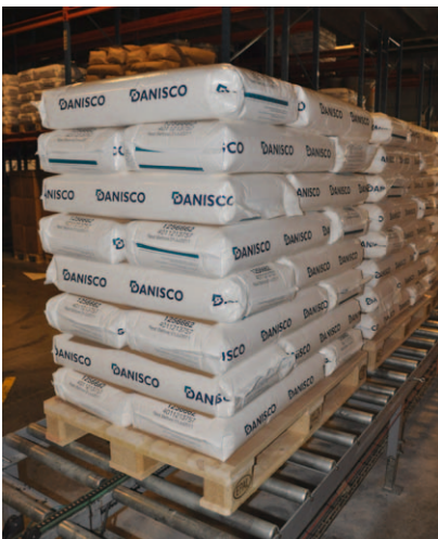
Les sacs d'émulsifiants sont efficacement maintenus ensemble grâce à une seule feuille de papier antiglisse 110 g/m 2 entre chaque couche.
