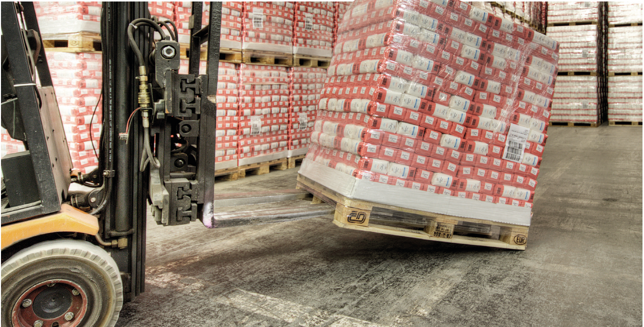
Les palettes sont conformes à la norme DIN EN 12195-1, en vertu de laquelle les palettes doivent pouvoir supporter une inclinaison de 27°.
